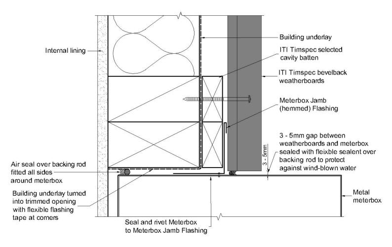
FIGURE 13. 21 BC 803 METER BOX SILL
